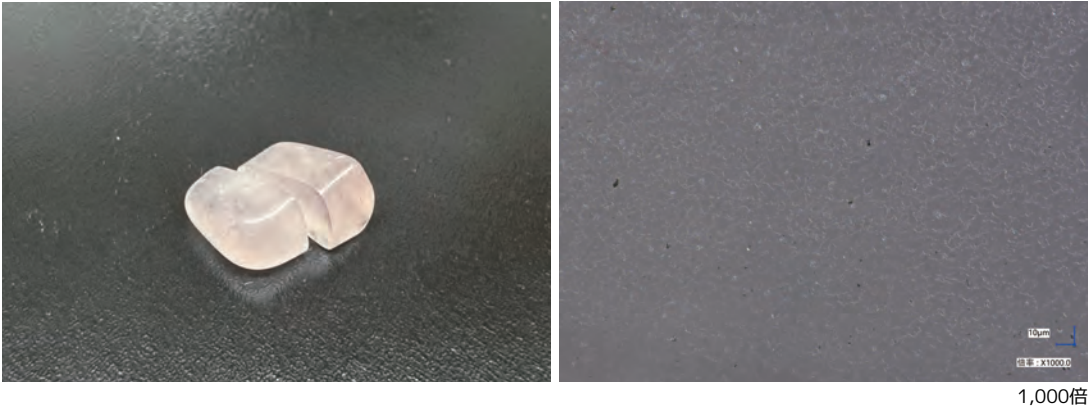
【使用機種】LUKUON-V 【切断方式】湿式切断 【ワイヤー】220μm
