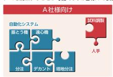
全行程の一部分を人手で実施し、その他をロボット で実施する方法。初期工程で試料の調製または最終 工程において試料の取り出しなどを人手にするこ とが多いです。
